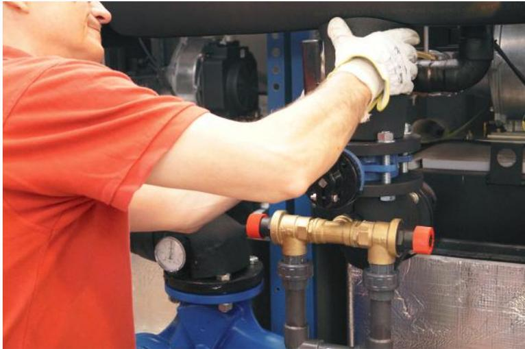
► Comprobación de todos los equipos autónomos de producción de calor Roof Top en nuestra fábrica antes de su suministro.
