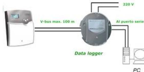
b) El dispositivo DATA LOGGER permite la conexión de un dispositivo de comunicación a PC a distancia, bien con un MODEM analógico o bien mediante un MODEM GSM. (KIT DATA-LOGGER CON MODEM ANALOGICO Ó DATA-LOGGER CON MODEM GSM). En la instalación
