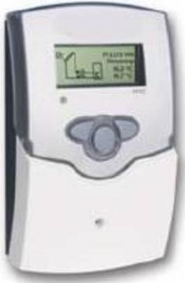
El contador WMZ-M1 es un calorímetro multifuncional tanto para instalaciones de energía solar térmica, pues tiene en cuenta el uso de mezcla glicolada, como para sistemas convencionales. A partir del fluido de trabajo definido, la evaluación de impulsos y la medición de las temperaturas de ida y retorno (mediante dos sondas de precisión PT1000), el calorímetro determina la cantidad de calor transferida.
